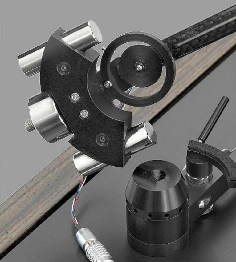
Oben links: Die Auflagekraft wird mit drei Gewichten eingestellt. Mit den beiden „Schlitten“ links und rechts an der Tonarmbasis erfolgt die Grundeinstellung. Das Hauptgewicht am Arm hinten dient für die Feinjustage. Mit dem verschiebbaren quer angeordneten Gewicht wird der Azimuth eingestellt
