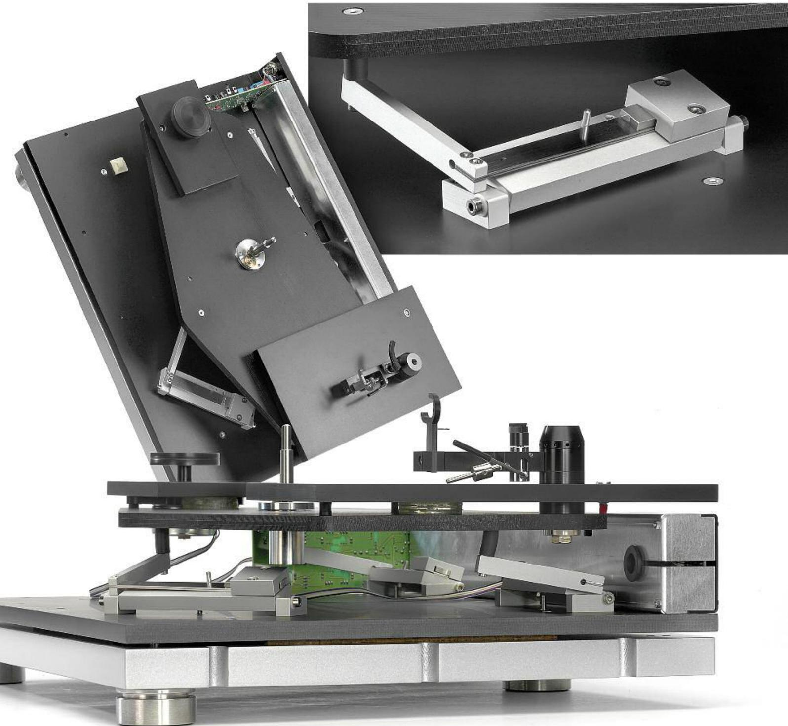
ge des Subchassis beeinflussen, kann die Höheneinstellung von unten an der Bodenplatte nachjustiert werden.
